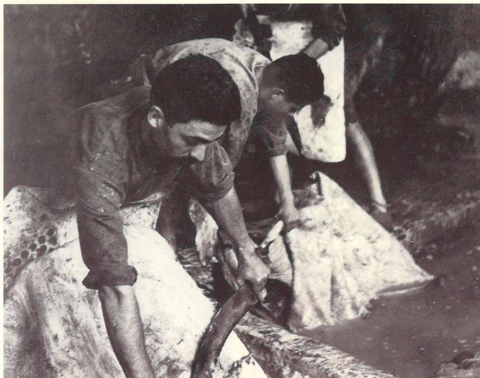
8. Operaris en el moment de efectuar l'operació de treure la carnassa de la pell amb el ferro de descarnar sobre la post.
