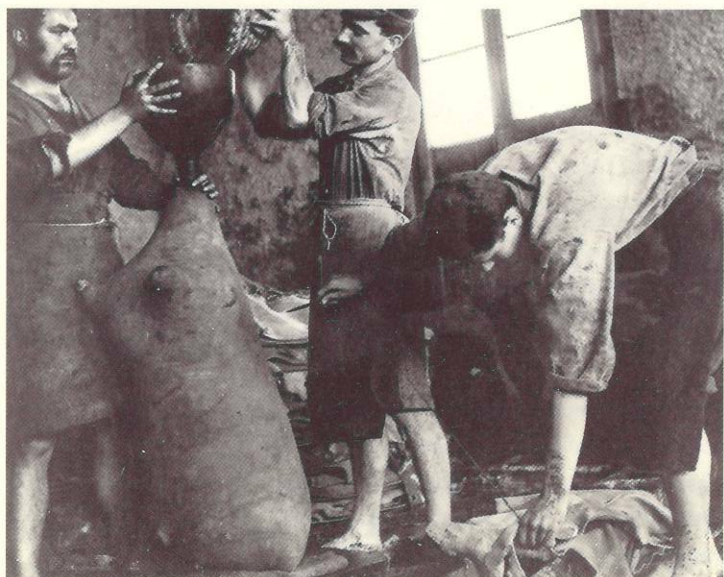
11 i 12. A les fotografies podem apreciar: primer, el moment d'introduir les pells al clot de colga; i, després, les pells cosides en forma de bot en el sistema de cosir els cuirs, en el moment de submergir-les en el Nau Dret.
